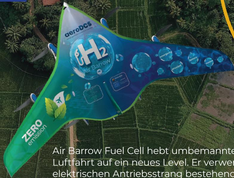
Air Barrow Fuel Cell hebt unbemannte Anwendungen in der Luftfahrt auf ein neues Level. Er verwendet einen hochmodernen elektrischen Antriebsstrang bestehend aus Brennstoffzellen und Elektromotoren mit mehrfacher Redundanz – es entsteht eine Kombination aus hoher Lebensdauer und hoher Zuverlässigkeit, mit der flexible Sensor-Nutzlasten sicherer, weiter und länger getragen werden können, als es bisher möglich war. Air Barrow Fuel Cell - ein Game-Changer in der Fernerkundung.
