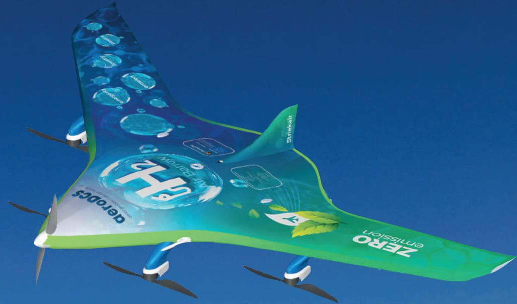
Der senkrechtstartende Flugträger mit Wasserstoffantrieb für hohe Reichweiten und flexibler Nutzlastverteilung, konsequente Leichtbaustruktur und konsequentes Design garantieren stabile Flugeigenschaften als UAV.
